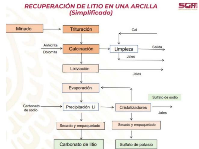
La planta comienza con una única línea de producción con un objetivo de tonelaje de  $\text{Li}_2\text{CO}_3$  de 17.500 toneladas por año. En el año 5, se pone en marcha una segunda línea de planta y la capacidad total de producción de  $\text{Li}_2\text{CO}_3$  aumenta a un mínimo de 35.000 t de  $\text{Li}_2\text{CO}_3$  por año.
